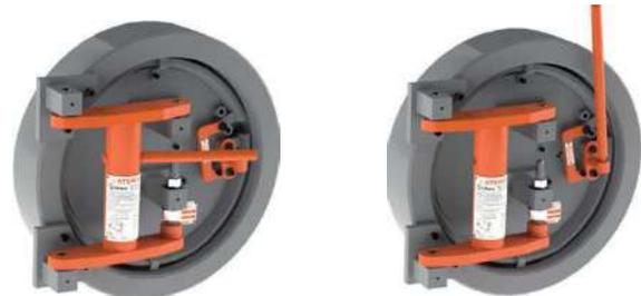
Colocación de barras y desplazamiento de tapa
